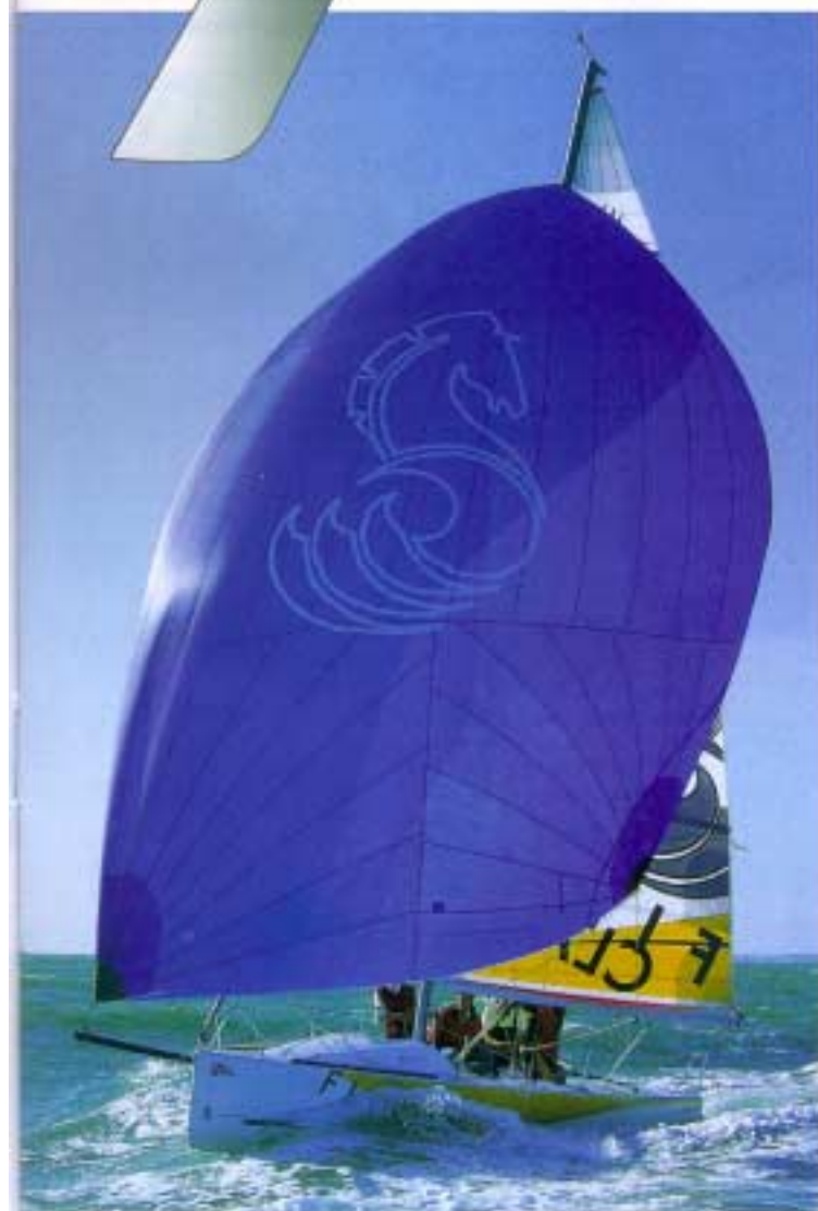
L'asymétrique s'amure à l'extrémité d'un bout-dehors rétractable mais le spi symétrique est également possible.
